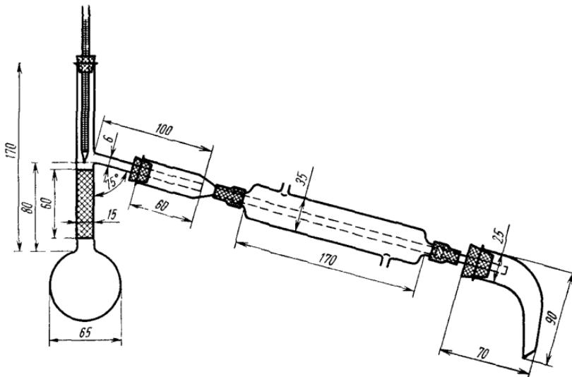
На конец холодильника надевают аллонж, под узкий конец которого ставят взвешенный цилиндр. Температуру измеряют термометром, укрепленным с помощью пробки в верхней части дефлегматора.
