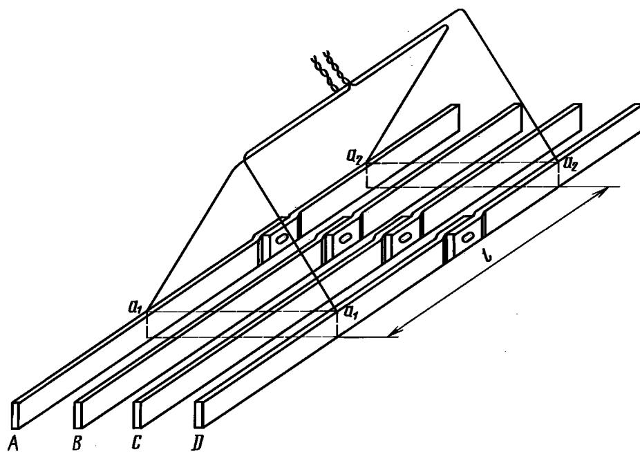
Кожух, оболочки и другие детали прямой секции шинопровода условно не показаны. Подключение к потенциометру проводится свитыми попарно проводами
