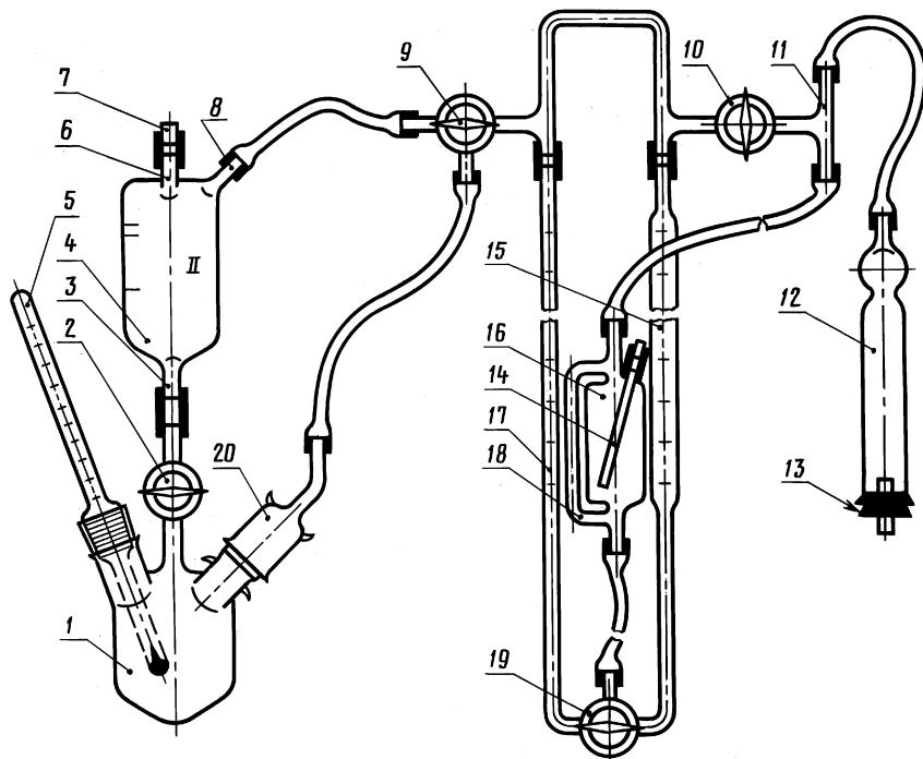
1 — сосуд I; 2, 10 — одноходовые краны; 3, 8 — отводы; 4 — сосуд II; 5 — термометр; 6 — трубка для ввода масла; 7 — заглушка; 9, 19 — трехходовые краны; 11 — тройник; 12 — осушитель; 13 — пробка с отверстием и стеклянной трубкой; 14 — трубка для залива масла; 15, 17 — бюретки; 16 — уравнительная склянка; 18 — сравнительная трубка уравнительной склянки; 20 — крышка
