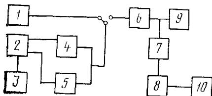
1—источник напряжения переменного тока; 2, 8—потенциометр постоянного тока; 3, 10—образцовые меры э.д.с. (нормальные элементы); 4—эталонный или образцовый преобразователь напряжения; 5—поверяемый прибор; 6—переключатель направления постоянного тока; 7—делитель напряжения постоянного тока, 9—источник напряжения постоянного тока
