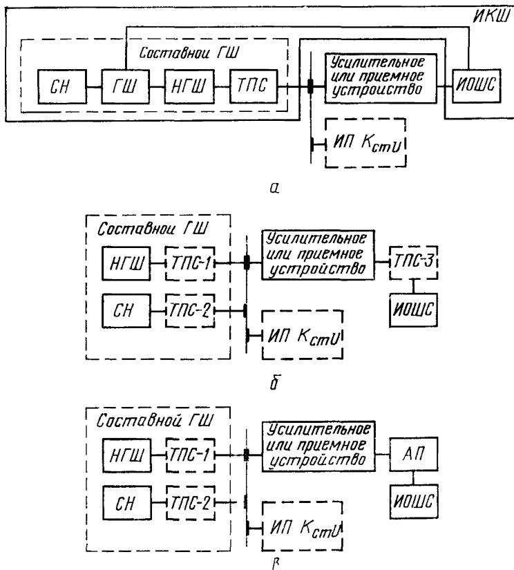
а—схема стенда для измерения ЭШБ устройств с использованием НГШ проходного типа и ИКШ в автоматическом режиме; б—то же, с использованием НГШ непроходного типа; в—схема стенда для прецизионных измерений
