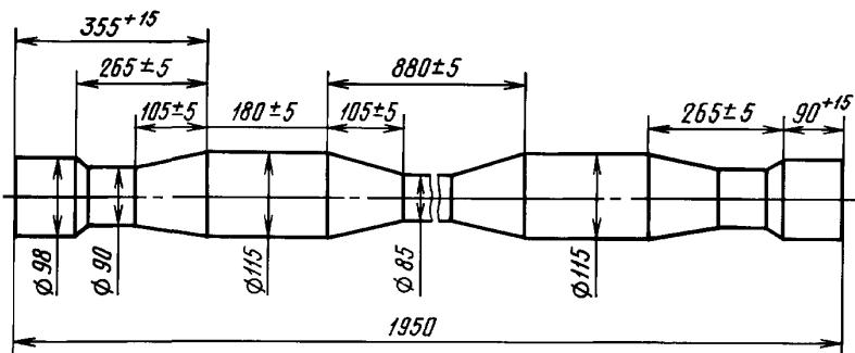
3. Предельные отклонения диаметров не должны превышать  $+0,8$   $-1,2$  мм.
