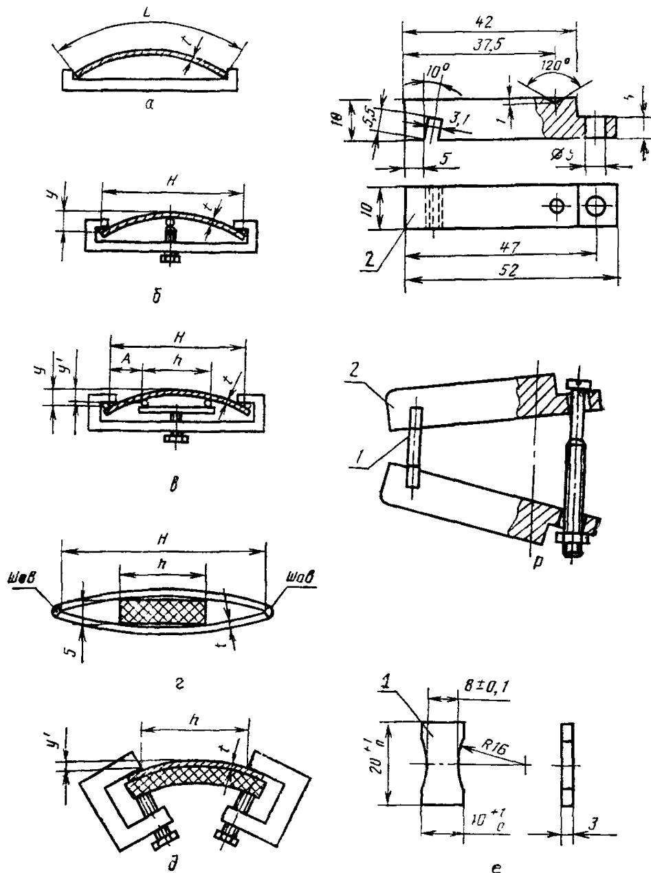
а — образец, нагруженный в двух точках б — образец, нагруженный в трех точках, в — образец, нагруженный в четырех точках, г — образец в виде двойного бруса, д — образец на сплошной опоре, е — образец, нагруженный с помощью рычага, 1 — образец, 2 — рычаг
