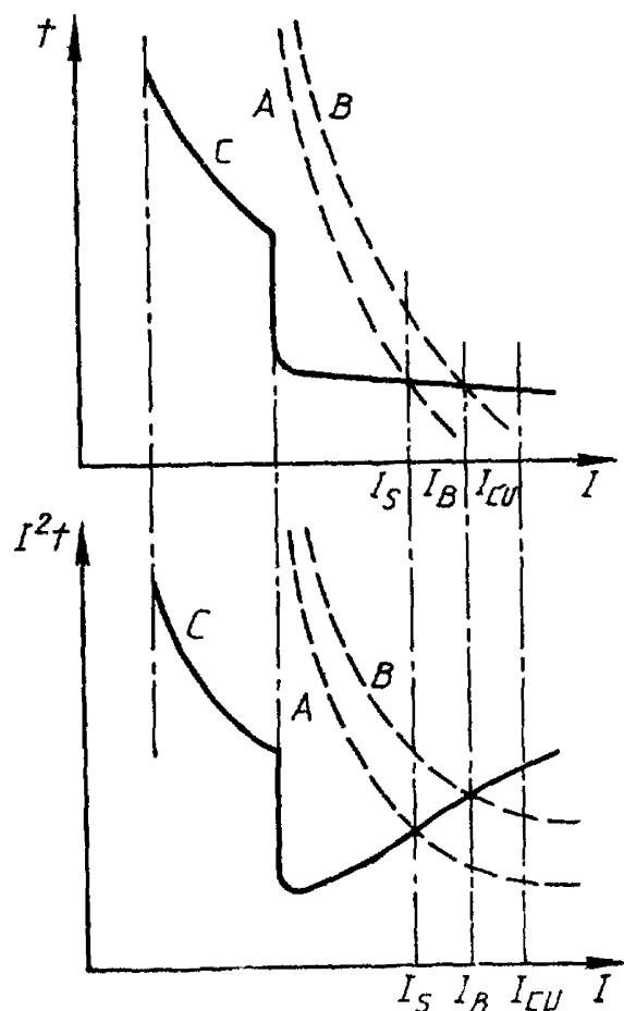
$I$  — ожидаемый ток короткого замыкания;  $I_{CU}$  — номинальная предельная наибольшая отключающая способность (4.3.5.2.1);  $I_S$  — предельный ток селективности (2.17.4);  $I_B$  — ток координации (2.17.6); А — преддуговая характеристика плавкого предохранителя; В — рабочая характеристика автоматического выключателя (время отключения/ток и  $I^2t$ /ток)
