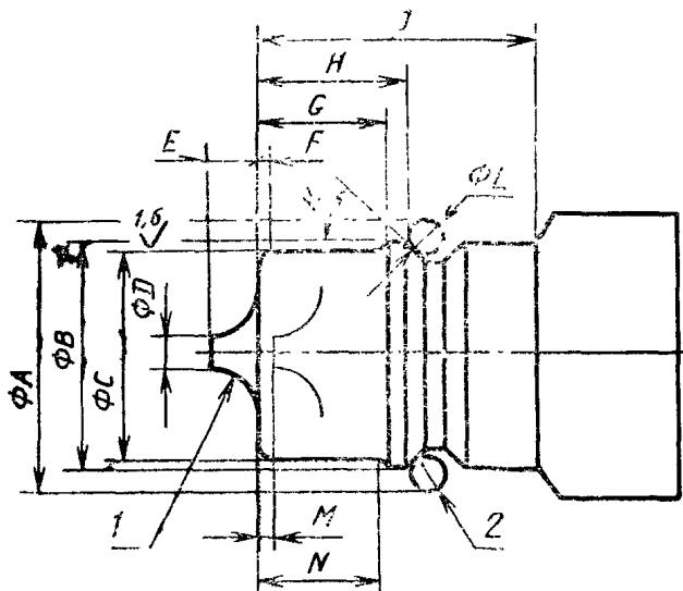
$\emptyset A$  — контролируемый диаметр;  $F$  — размер скругления или фаски (форма — по выбору);  $H$  — размер до шарика;  $M$  — размер при полностью открытом клапане — «до упора»;  $N$  — минимальная длина образующей на  $\emptyset C$ ;  $I$  — клапан (форма — произвольная); 2 — место контакта шарика
