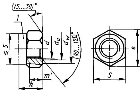
*I* — стопорящий элемент (допускаются различные варианты исполнения)
