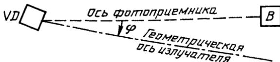
*VD*—проверяемый излучатель; *B*—фотоприемник;  $\varphi$ —угол между осью фотоприемника и геометрической осью излучателя
