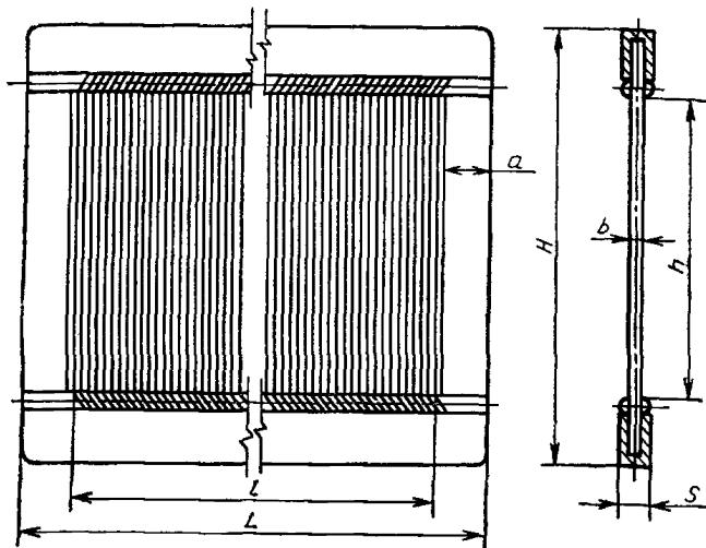
*a* — ширина скобки; *b* — ширина зуба берда; *s* — толщина накладки; *h* — высота в свету; *H* — общая высота; *l* — рабочая ширина; *L* — общая ширина
