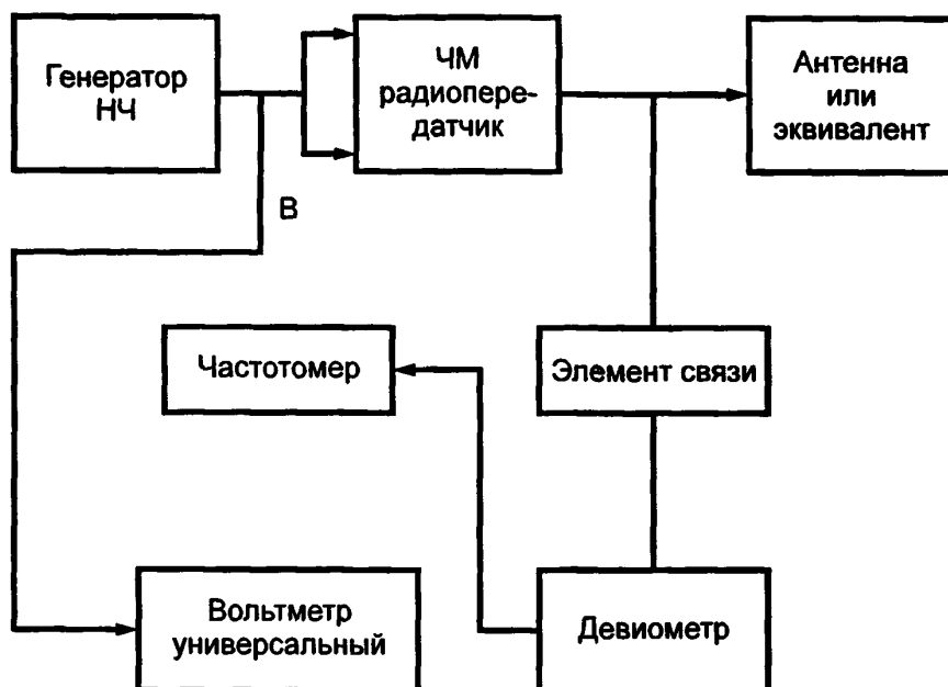
Рисунок 1 — Схема измерений параметров систем стереофонического радиовещания
