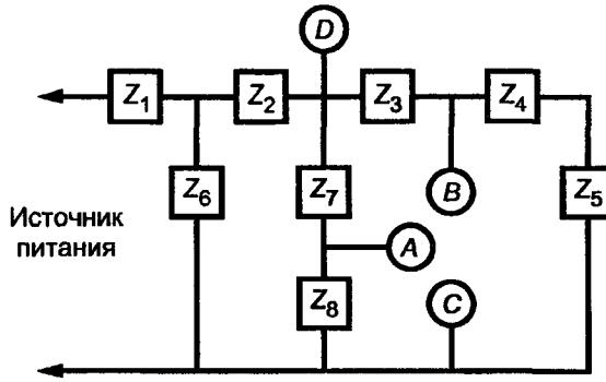
*D* — точка, максимально удаленная от источника питания, в которой максимальная рассеиваемая на внешней нагрузке мощность превышает 15 Вт. *A* и *B* — точки, ближайшие к источнику питания, в которых максимальная рассеиваемая на внешней нагрузке мощность не превышает 15 Вт; они являются маломощными точками
