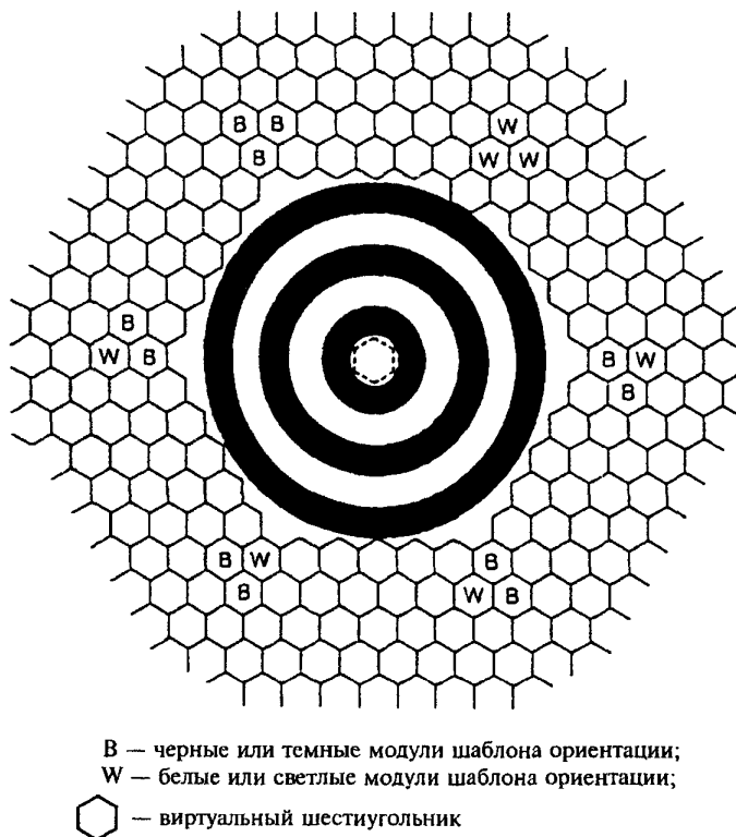
Рисунок 3 — Структура символа MaxiCode (с шаблоном поиска и модулями ориентации)
