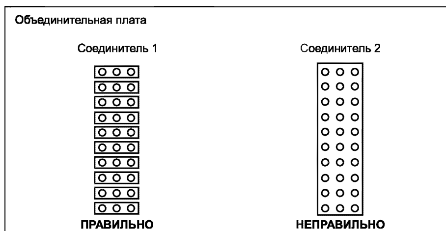
Рисунок П.3 — Вырезы в объединительной плате для соединителей
