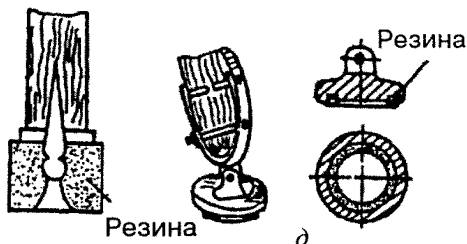
Рис. 5.3. Стремянки: а – деревянные; б – металлическая; в – трап для спуска в котлован; г – металлический острый наконечник для установки лестниц и стремянок на земле; д – резиновые башмаки для установки лестниц и стремянок на асфальтовых, бетонных и других подобных полах
