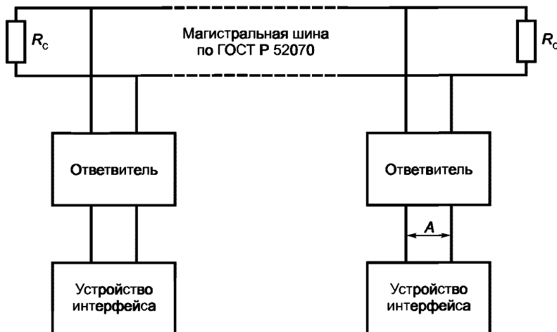
Рисунок 1 — Измерение активного сопротивления ответвителя с трансформаторной связью
