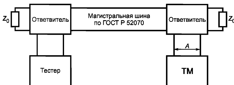
Рисунок 2 — Общая схема тестирования ТМ с использованием физической магистрали
