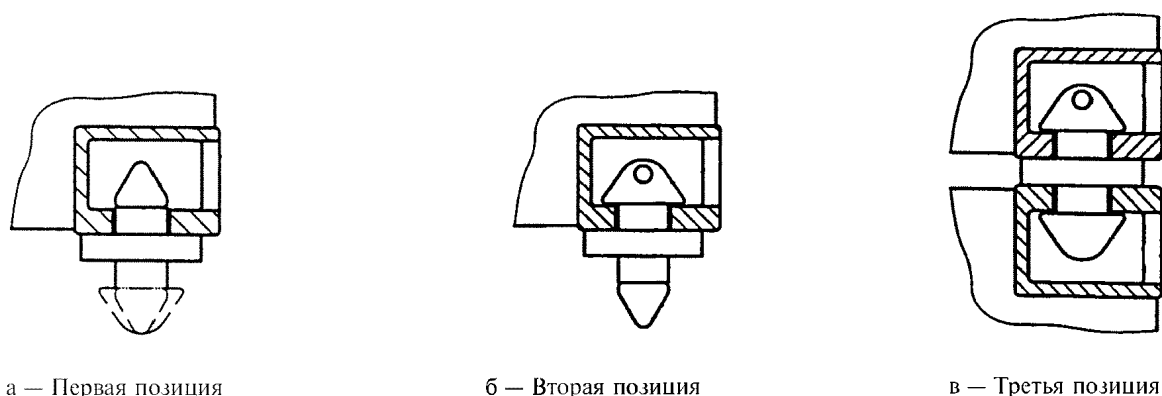
Рисунок А.4 — Полуавтоматический стопор, установленный в верхний угловой фитинг
