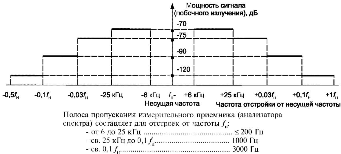
Рисунок 1 — Пределы средней мощности побочных радиоколебаний, передаваемых в антенно-фидерное устройство
