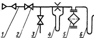
1 — воздушная линия; 2 — проходной кран; 3 — зажим; 4 — реометр с диафрагмой; 5 — испытуемый фильтр-поглотитель; 6 — U-образный мановакуумметр
