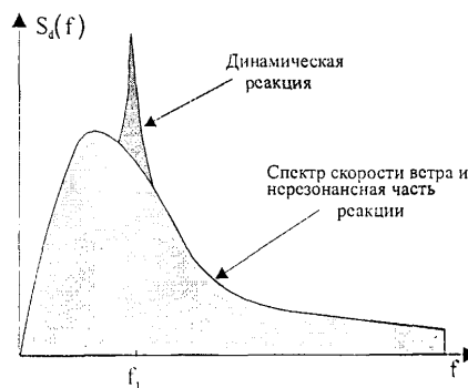
Рис. П 1.2 Энергетический спектр динамической реакции сооружений при действии ветра; Выделена резонансная реакция на собственной частоте f_1
