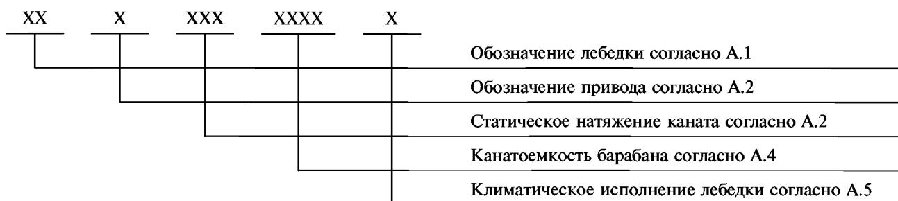
А.6 Пример условного обозначения лебедки с электрическим приводом со статическим натяжением каната на первом слое навивки 100 кН, с канатоемкостью барабана 1500 м для умеренного климата:
