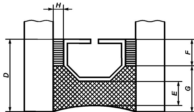
D — общая глубина герметизирующего слоя; F — глубина внутреннего (первого) герметизирующего слоя; G — глубина второго герметизирующего слоя; E — глубина наружного герметизирующего слоя; H — толщина первого герметизирующего слоя
