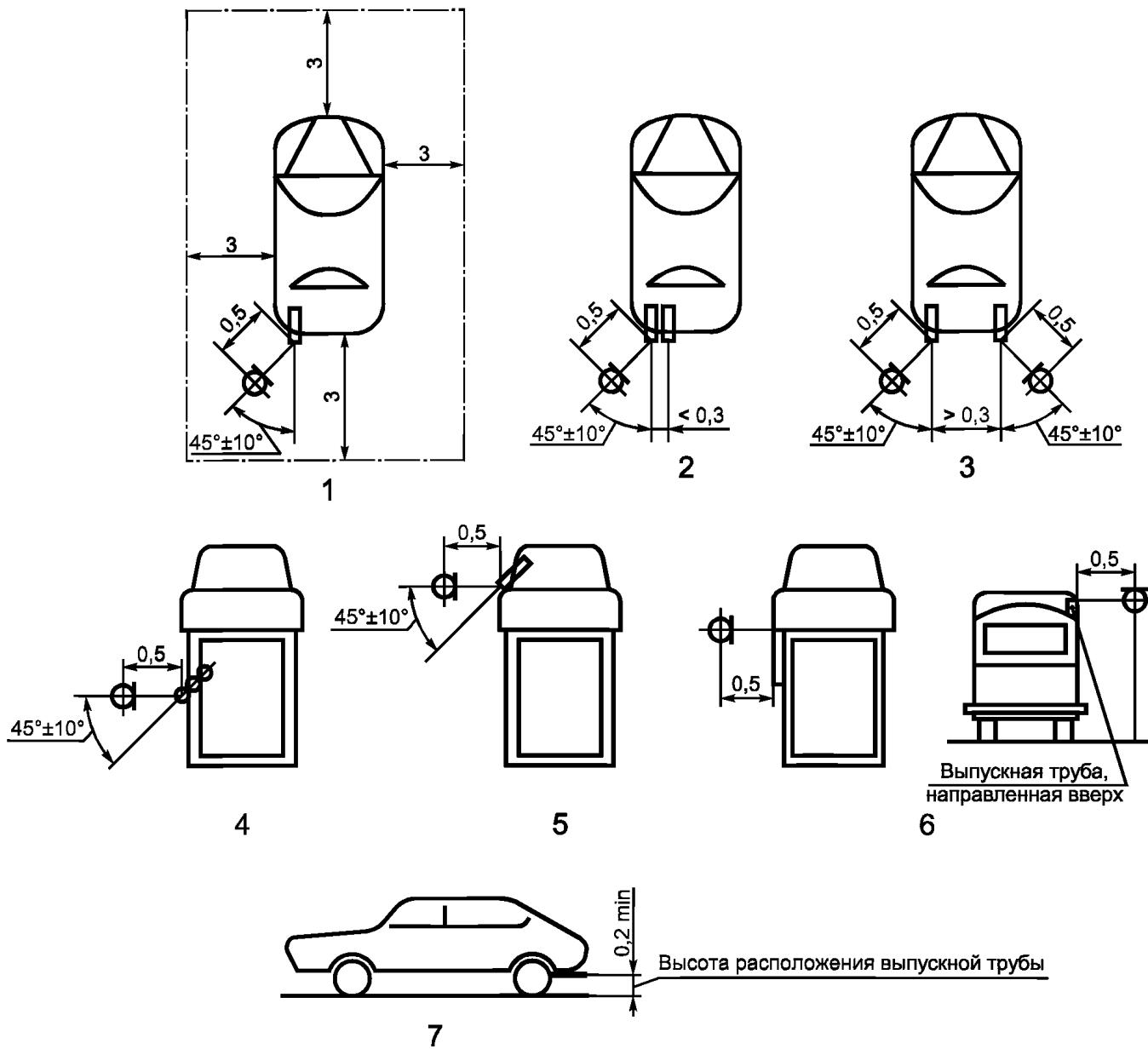
1—5 — установка микрофона относительно выпускной трубы в горизонтальной плоскости; 6 — установка микрофона относительно вертикально расположенной выпускной трубы; 7 — установка микрофона относительно выпускной трубы в вертикальной плоскости
