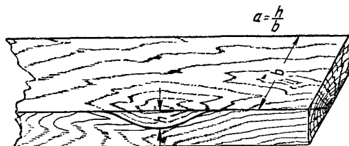
Черт. 6. Измерение завитка на доске тангентальной распиловки. Значения h и b —см. черт. 5
