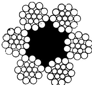
Настоящий стандарт распространяется на стальные канаты (тросы) с точечным касанием, разного диаметра проволок в прядях, типа ТК, с одним органическим сердечником.
