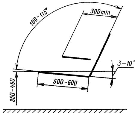
Примечание. Размеры указаны в вертикальной плоскости симметрии.
