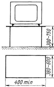
3. При проектировании изделий для установки телевизоров их функциональные размеры, определяемые по настоящему стандарту, должны быть увязаны с технической документацией на элементы мебели, утвержденной Министерством лесной и деревообрабатывающей промышленности СССР.
