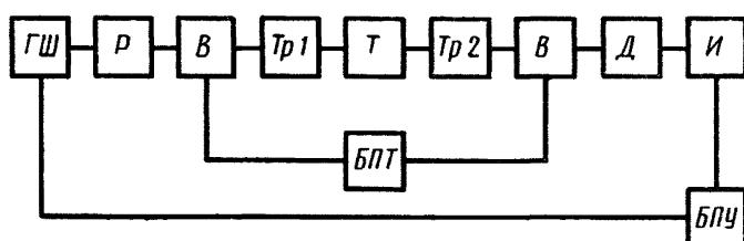
ГШ—генератор шума; Р—развязка генератора шума (в ряде случаев может отсутствовать); Тр1—входной трансформатор полных сопротивлений; Т—измеряемый транзистор; Тр2—выходной трансформатор полных сопротивлений; И—индикатор; БПУ—блок питания и управления измерителя коэффициента шума; БПТ—блок питания транзистора по постоянному току; В—ввод питания (при подаче питания через контактное устройство В может отсутствовать); Д—вентиль (в ряде случаев может отсутствовать)
