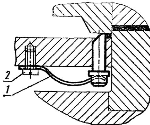
1 — пружина по ГОСТ 18753-73; 2 — винт М5×12,66 ГОСТ 1491-72
