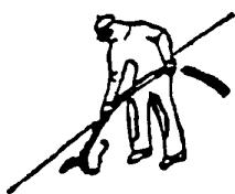
3. Заполнение трещин вяжущим с небольшим избытком при помощи шланга.
