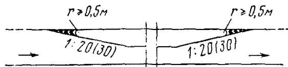
Рис. 7.3. Схема разметки торцов боковых разделительных полос
