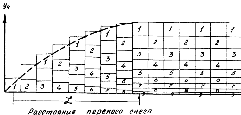
Р и с. 9. Зависимость количества переносимого снега от дальности переноса
