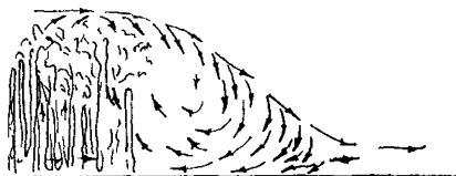
Р и с. 2 5. Образование зоны циркуляции за густым лесом
