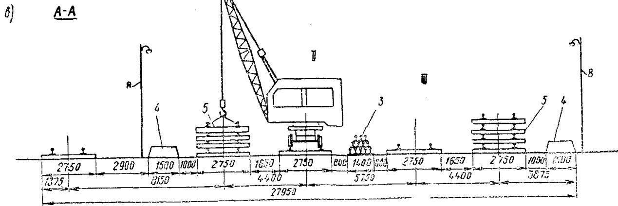
Схема базы для монтажа звеньев рельсо-шпальной решетки с применением железнодорожных кранов:
