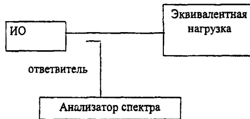
Рисунок 6 - Структурная схема измерения плотности передаваемой выходной мощности
