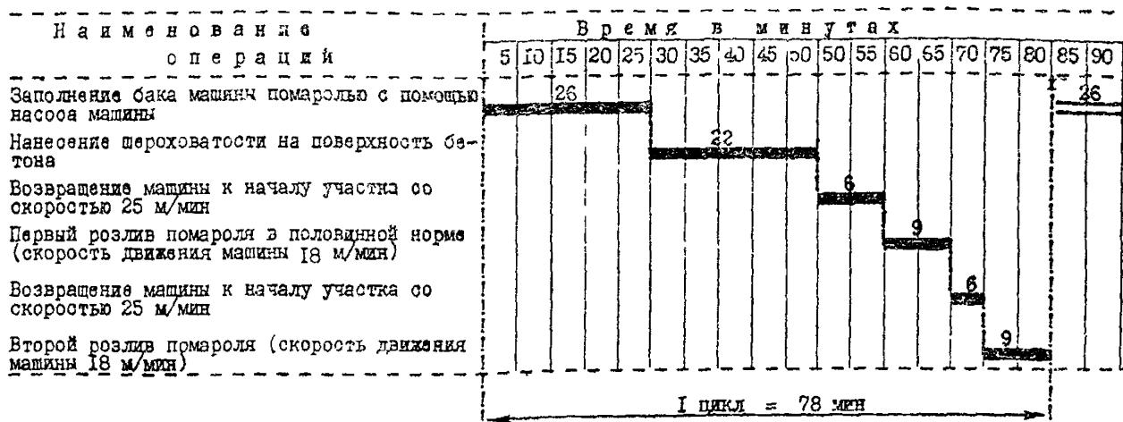
Производительность двухполосного финишера ТС-280 за смену (8 час) с учетом коэффициента использования машины по времени в течение смены  $K_B = 0,75$  составляет:
