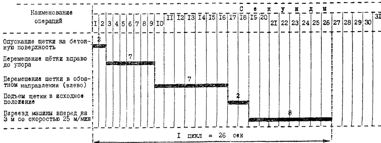
Нанесение шероховатости на участке длиной 150 м производят за:  $\frac{150 \cdot 26}{3 \cdot 60} = 22$  мин.
