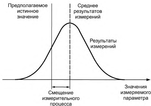
Рисунок 2 — Смещение измерительного процесса
