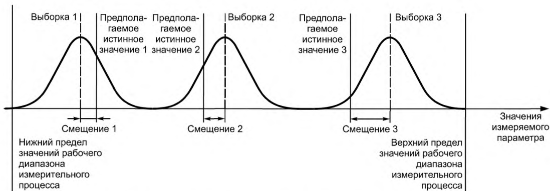
Рисунок 3 — Линейность смещения измерительного процесса
