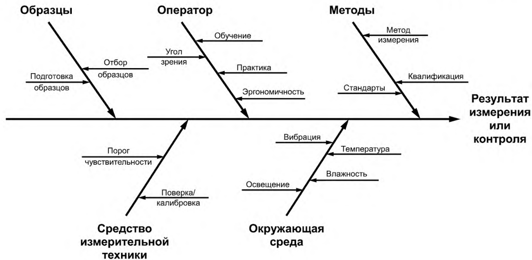
Рисунок 13 — Группы причин изменчивости измерительного или контрольного процесса
