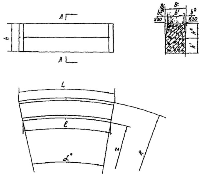
Рис. 1. Общий вид криволинейных бортовых камней.
