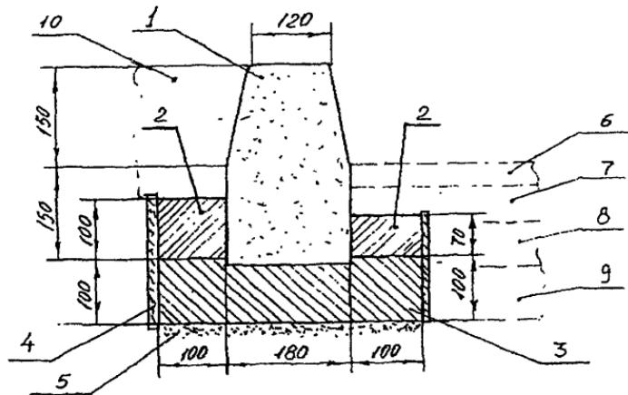
Рис. 2. Схема установки бортового камня
