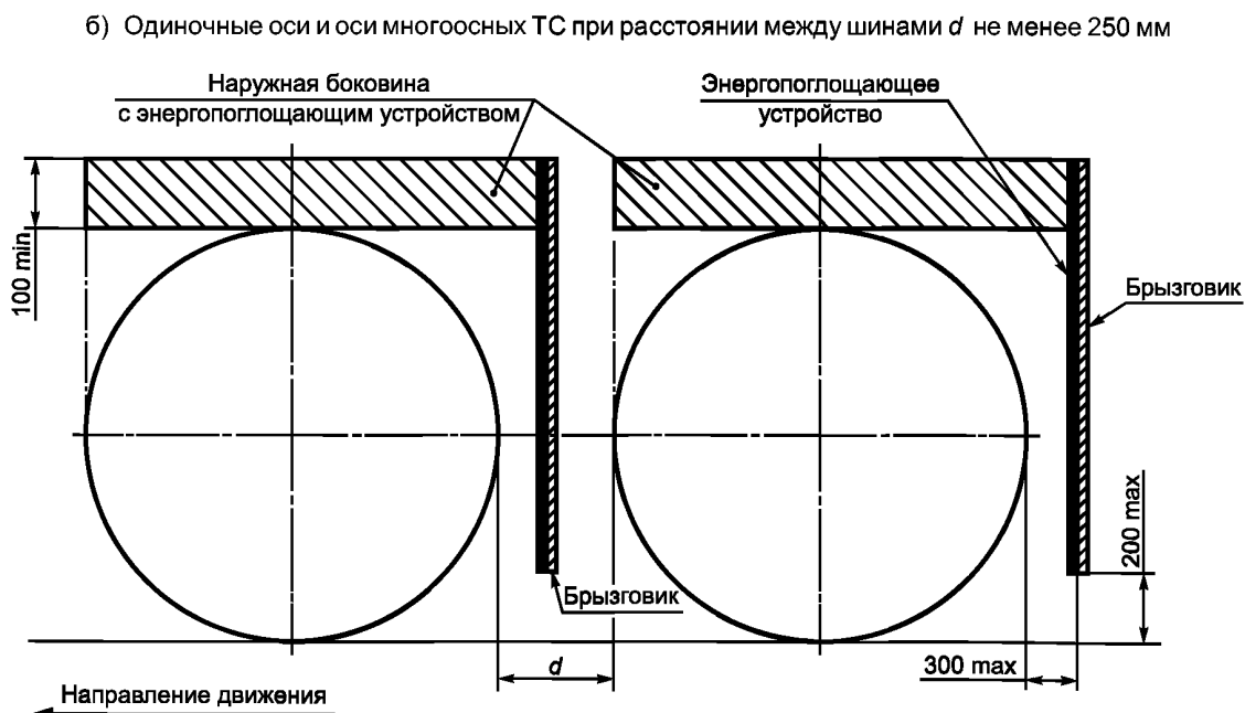
Рисунок 4 — Схема системы защиты от разбрызгивания с энергопоглощающими устройствами для осей с неуправляемыми и самоустанавливающимися колесами
