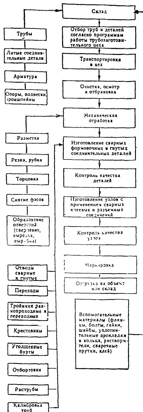
Рис. 8.1. Схема технологического процесса изготовления деталей и узлов пластмассовых трубопроводов
