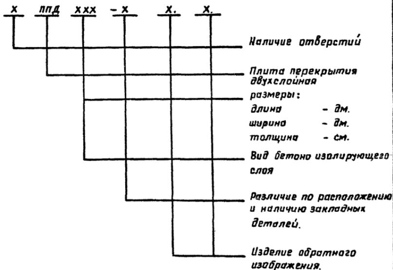
Например, ППД 50.12.40-Т – плита перекрытия двухслойная, длиной 50 дм., шириной 12 дм., толщиной 40 см, изолирующий слой из тяжелого бетона ( $m$ )  $f_0 = 2400 \text{ кг/м}^3$ .
