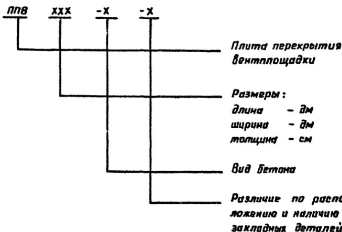
Например, ППВ 54.12.16-Т - плита перекрытия вентплощадки длиной 54 дм, шириной 12 дм, толщиной 16 см из тяжелого бетона ( $\gamma = 2400 \text{ кг/м}^3$ )
