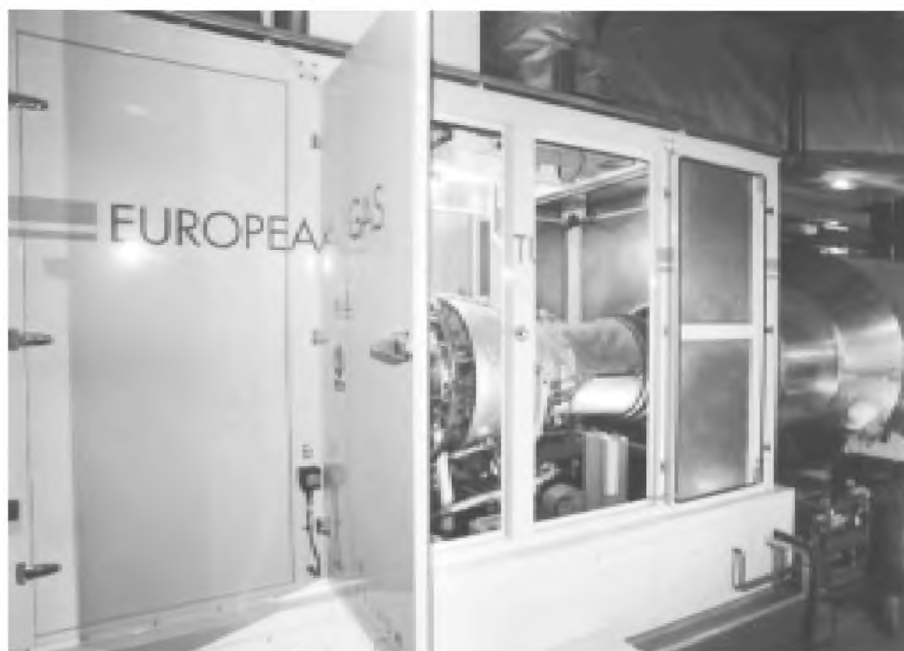
Рисунок В.11— Газовая турбина с кожухом (панель для доступа открыта)
