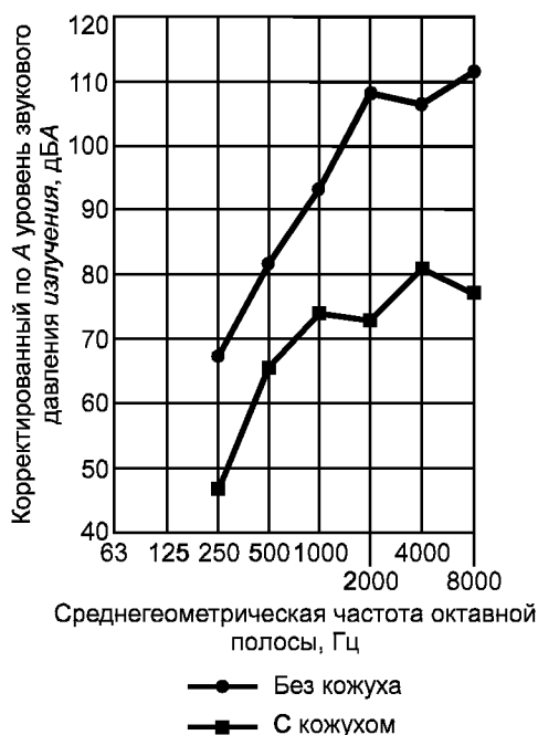
Рисунок В.5 — Спектр корректированных по A уровней звукового давления излучения на рабочем месте станка с двумя пилами для резки профилей
