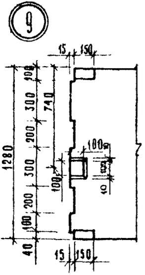
Расположение шпонок в торцах панелей
