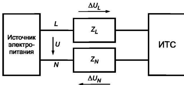
$U$  — напряжение «фаза — нейтраль» источника электропитания;  $Z_{L, N}$  — полное сопротивление проводников и устройств измерения тока; ИТС — испытуемое ТС;  $\Delta U_L$ ,  $\Delta U_N$  — падение напряжения на полном сопротивлении  $Z_L$  и  $Z_N$ ;  $L$  — фазный проводник;  $N$  — нейтральный проводник
