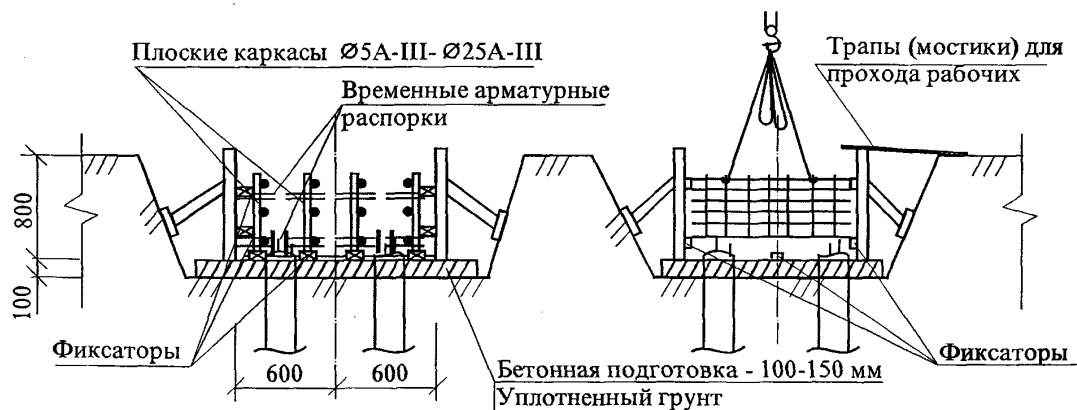
Рисунок 2 – Схема установки арматуры из плоских арматурных каркасов и сеток и опалубки ленточных фундаментов
