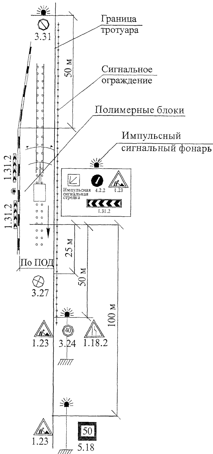
Рисунок 10 – Схема разработки грунта на проезжей части автодороги
