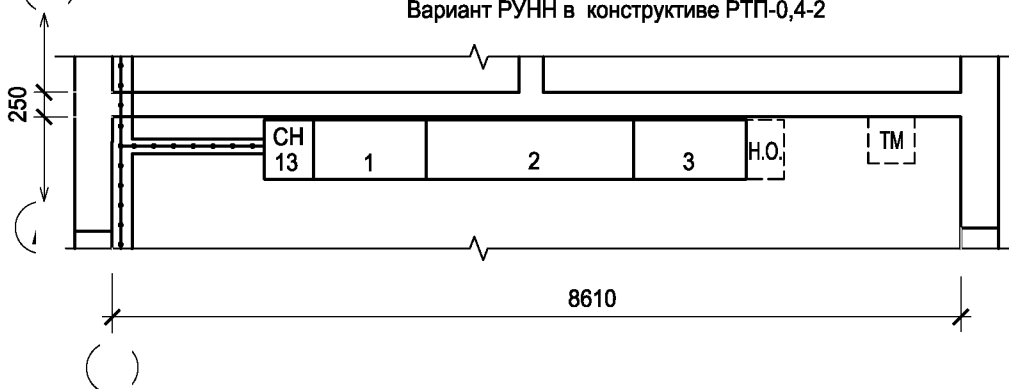
Вариант РУНН в конструктиве РТП-0,4-2
