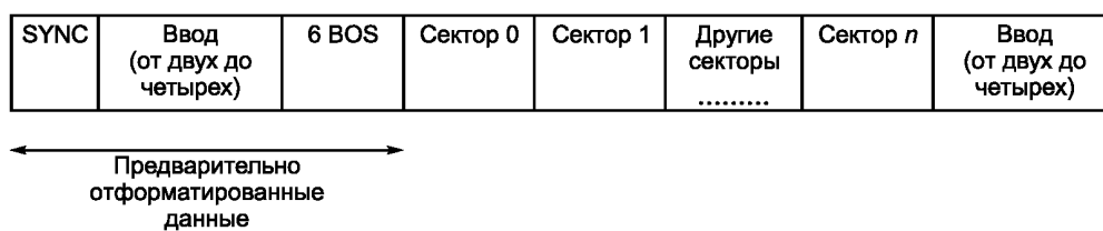
Рисунок В.5 — Структура полной дорожки, секторы типов 0—5
