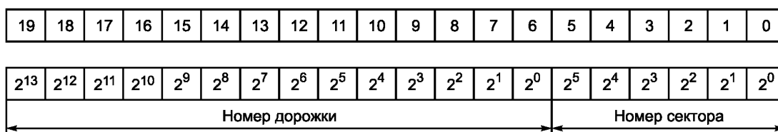
Рисунок В.4 — Формат адреса сектора и дорожки
