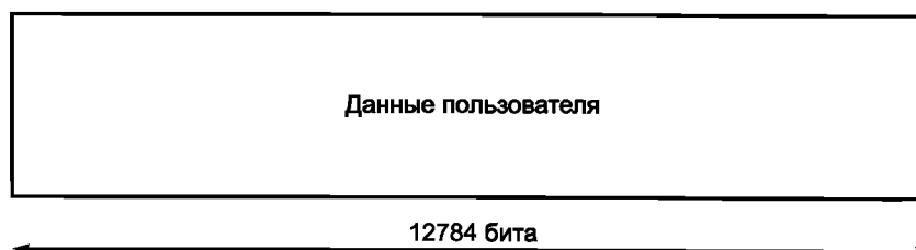
Рисунок В.11 — Структура блока данных сектора типа 5
